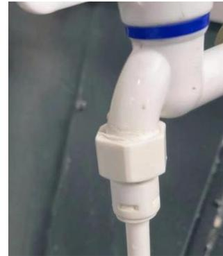
2) **水源和超纯水机的连接:** 从配件包中取出 pp 棉，将 L 型弯头插在 PP 棉两端，用 PE 管（白色）截取相应长度连接 pp 棉两端的 L 型弯头接口，管子一端与水龙头上已安装好的进水三通侧端或进水直接接口连接，另一端插进水机背部“自来水”接口，如下图所示。
